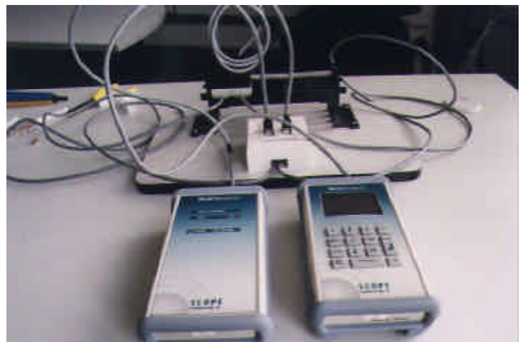
ścieżka 6. Testowanie torów przy pomocy analizatora sieciowego WireScope 155
